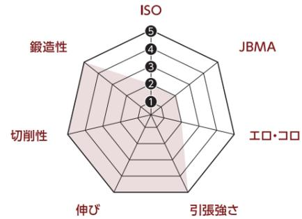
切削性、鍛造性に優れている一般的な鍛造用快削黄銅です。特に鍛造性に優れています。腐食環境下での使用は推奨できません。
