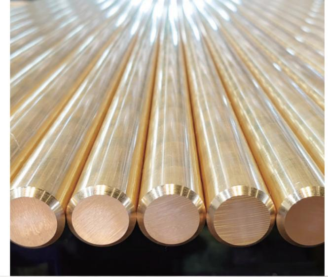
従来の耐脱亜鉛黄銅棒は、熱間鍛造加工を行う場合、加工後に熱処理が必要とされていました。熱処理によって結晶を制御しなければ、良好な耐脱亜鉛性を発揮できなかつたのです。サンエツ金属のZ00は、熱間鍛造後に一切の熱処理なしで最高水準の耐脱亜鉛性を有する、サンエツ金属の最先端の結晶制御技術によって生み出された画期的な合金です。
