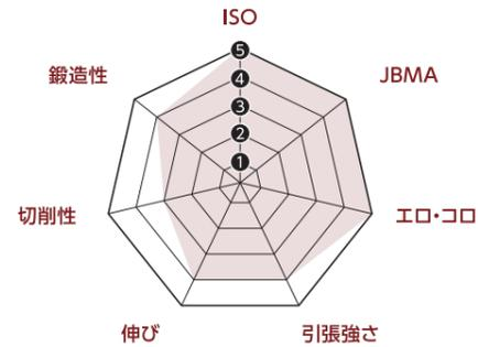
鍛造性に優れた、熱処理不要の耐脱亜鉛黄銅ですから、どのような鍛造条件でも優れた耐食性を示します。
