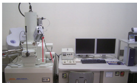
電界放射型走査電子顕微鏡:EDX、WDX搭載
