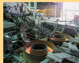
押出工程のコイル巻取機
