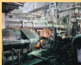
2,500トン複動式直接押出機
