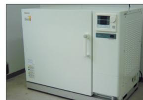
精密恒温装置(耐熱性試験)
